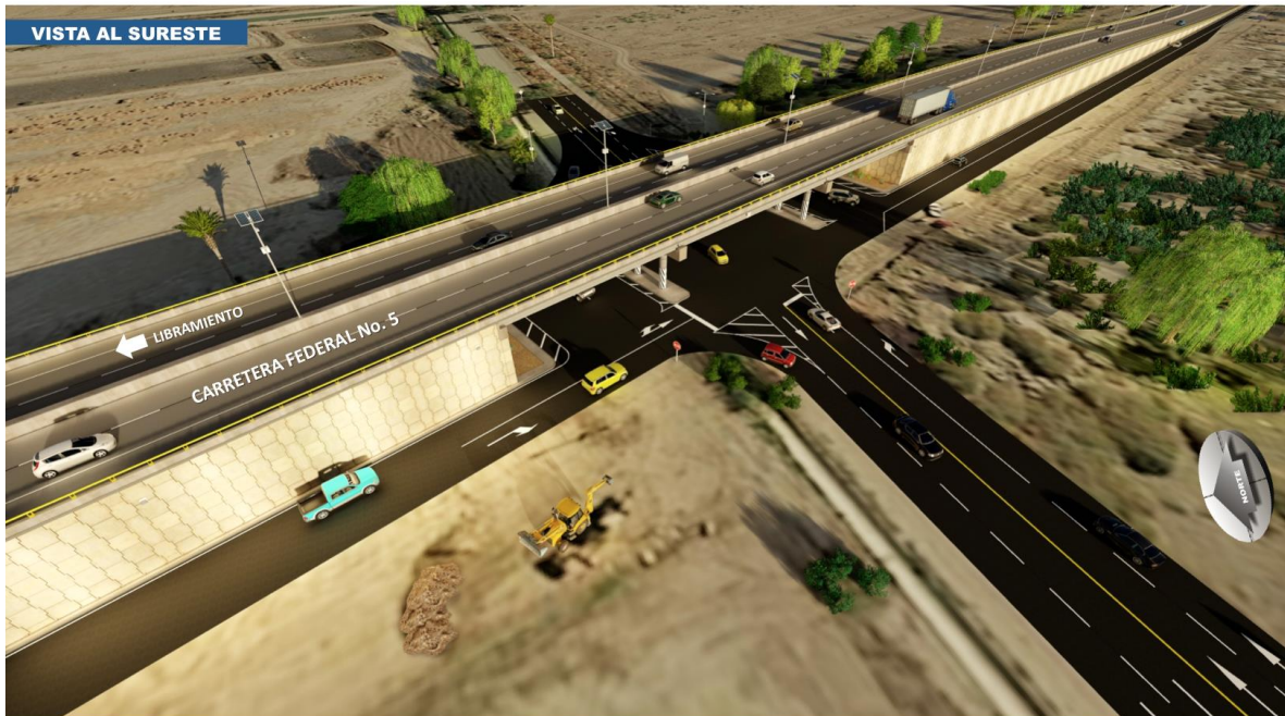
FIGURA 1-2 SE MUESTRA UN PERFIL DEL PUENTE QUE ESTÁ DISEÑADO PARA FACILITAR EL PASO VEHICULAR INFERIOR ASÍ COMO EL SUPERIOR SOBRE EL PUENTE 8+890 AL 10+840 EN UNA LONGITUD DE 1950 M
