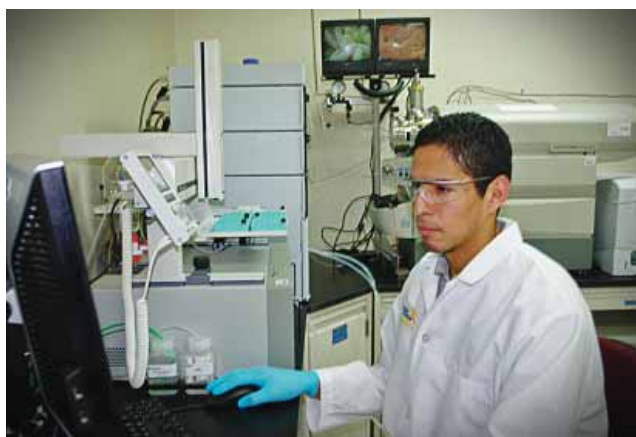
Equipo de cromatografía del laboratorio de periciales para identificación de sustancias, Mexicali.
